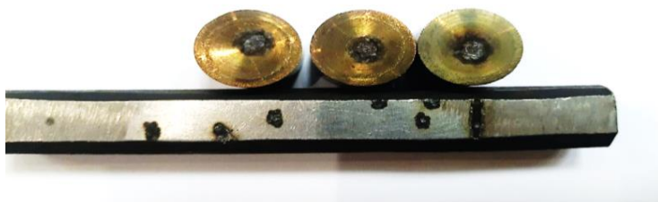
Рис.1. Плями «пропалення» на поверхні металевих проб після проведення атомного емісійного спектрального аналізу
