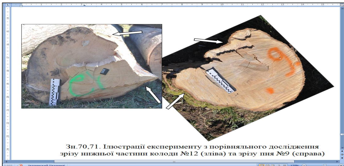
Рис. 3. Ілюстрація експерименту з порівняльного дослідження зрізу нижньої частини колоди та фрагменту зрізу пня в лабораторних умовах
