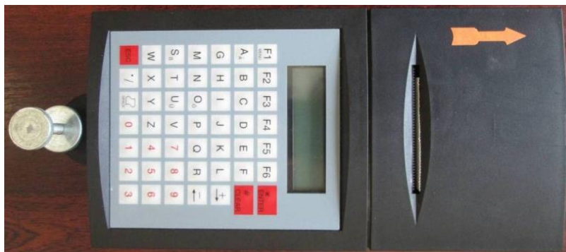
Рис. 1. Деселерометр VZM-300 компанії «МАНА»
