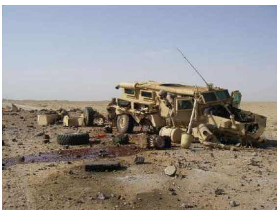
Рис. 1. Вигляд транспортного засобу після підриву міни під днищем
