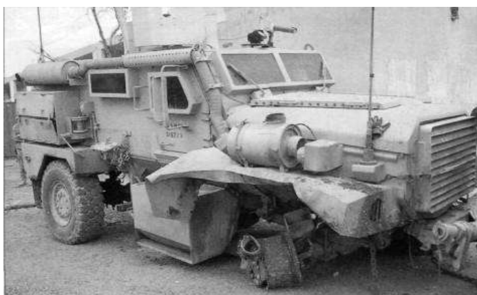
Рис. 2. Вигляд транспортного засобу після підриву міни під переднім колесом
