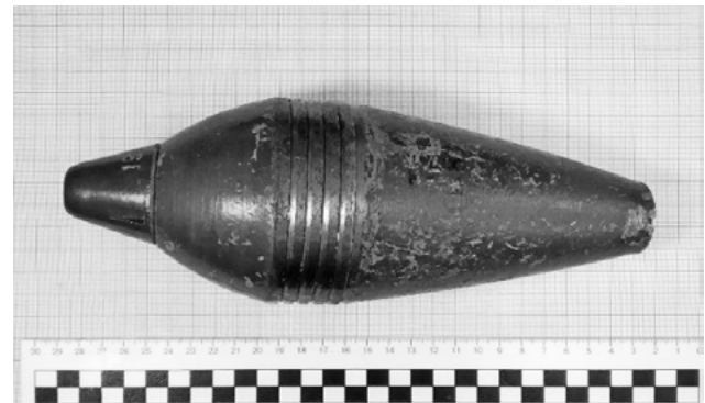
Рис. 3. Корпус 82-мм мінометної міни без стабілізатора
