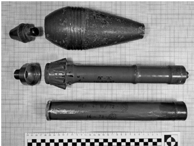
Рис. 2. Складники саморобного вибухового пристрою на основі корпусу 82-мм мінометної міни та маршового і стартового порохових двигунів пострілу ПГ-7ВЛ
